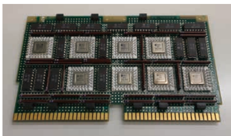
HITAC M-180 論理パッケージ：LSI と汎用 ECL 型 IC の混在型論理パッケージ（左）と汎用 ECL 型 IC のみの論理パッケージ（右）
