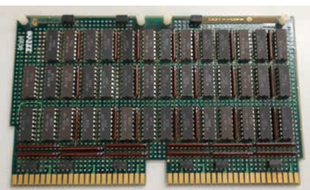
HITAC M-180 論理パッケージ：LSI と汎用 ECL 型 IC の混在型論理パッケージ（左）と汎用 ECL 型 IC のみの論理パッケージ（右）
