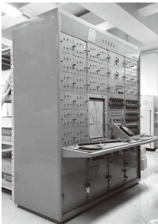
図-2 霞が関ビル設計に使用されたアナログ計算機 SERAC（国立科学博物館所蔵）
