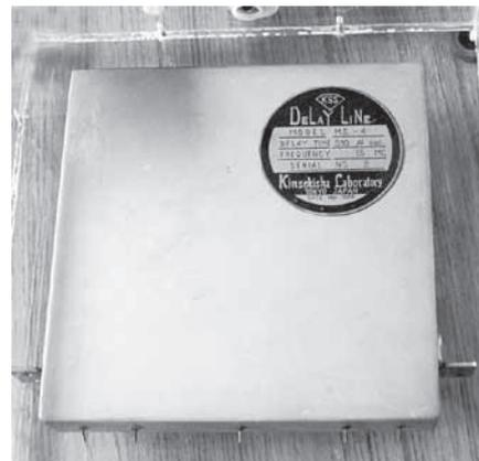
ETL Mark IIIに使用した金石舎研究所製の遅延線記憶素子(産総研所蔵)
