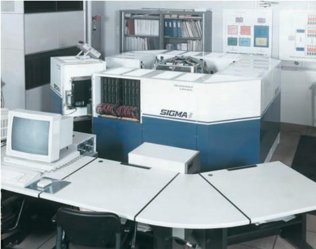
図-2 128プロセッサSIGMA-1
