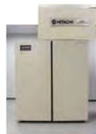
大型コンピュータの周辺装置として設計された高速物理乱数発生装置
