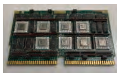
LSI と汎用 ECL 型 IC の混在型論理パッケージ
