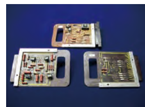
手前左がクロックパルス発生回路, 手前右が論理ゲート回路, 奥が論理基本回路
