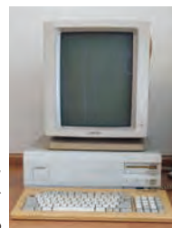
NWS-830 (1987年)。ビットマップ・ディスプレイとLAN通信機能を備える
