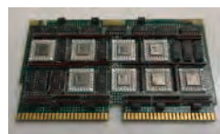
LSI と汎用 ECL 型 IC の混在型論理パッケージ
