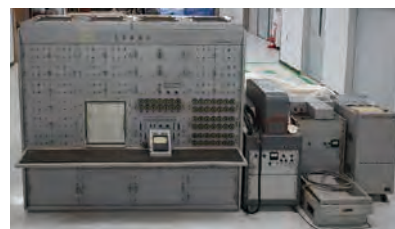
SERAC（本体、光電管式関数発生機と記録装置）
