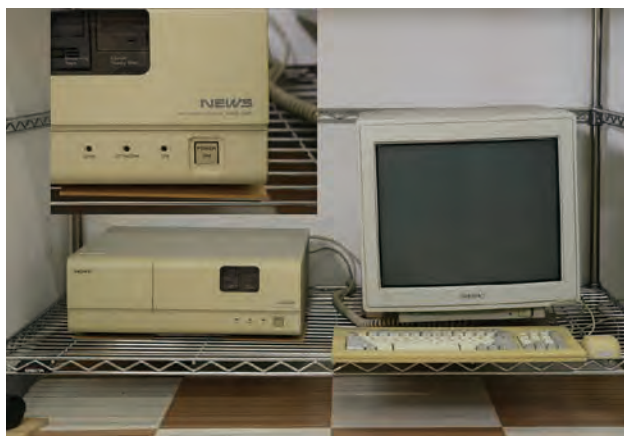
NWS-3860 (1991 年). CPU に RISC プロセッサである MIPS R-3000 を採用している。
