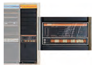
PDP-8/I とそのコンソール・パネル
