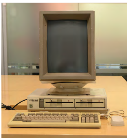
PC-100の全景。縦に設置したカラー・グラフィックディスプレイはXerox社ALTOのデザインを踏襲したものである
