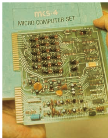
4004 チップを使った電卓の基板
