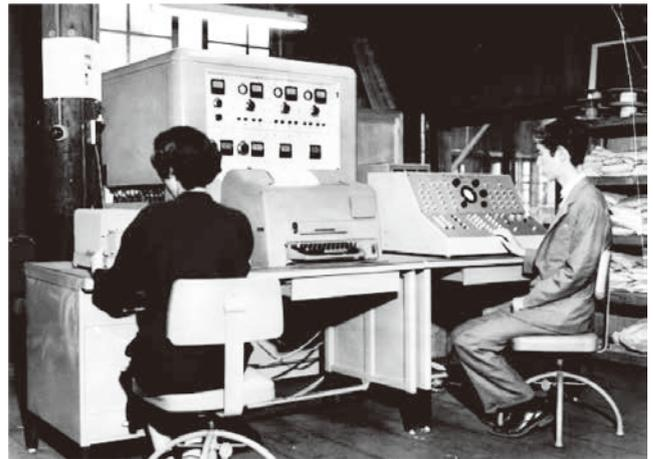
日本電子測器で開発されたPD 1516パラメトロン計算機
