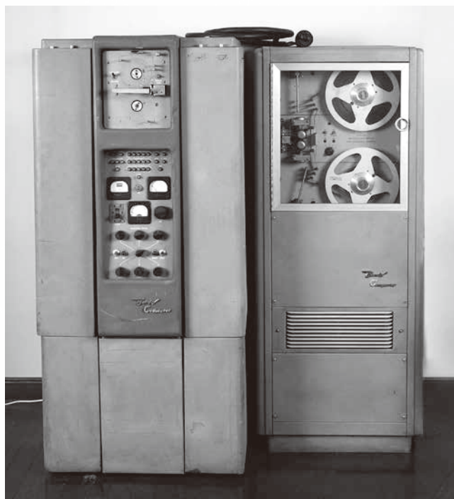
鉄道技術研究所に導入されたものと同型の Bendix G15D (東京理科大学近代科学資料館所蔵。写真提供：同資料館)
