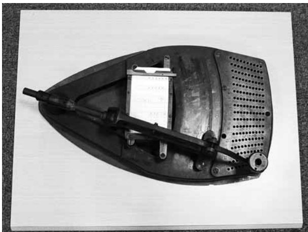
図-9 亀の子型穿孔機(情報処理学会「コンピュータ博物館」より)
