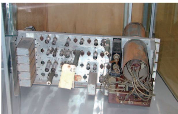
TAC ブラウン管記憶装置 (東京農工大学情報工学科西村コンピュータコレクション所蔵)
