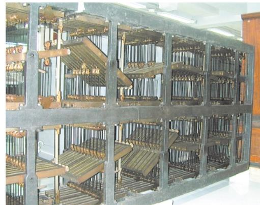
図-12 9元連立方程式求解機
